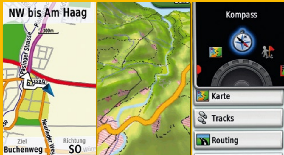
Ausgestattet mit einer routingfähigen Vektorkarte liefert das Colorado Abbiegehinweise - auch per Sprachausgabe. Die 3D-Darstellung funktioniert derzeit nur mit Topo-Karten aus den USA. Der deutschen Version fehlen Daten. Das Scrollrad erlaubt eine Einhandbedienung: das ist eine echte Erleichterung in der Praxis.
