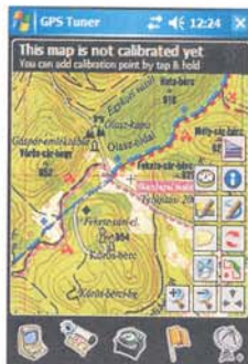
Beim Offroad-Navi-programm GPS Tuner orientieren Sie sich mit Hilfe von eingescannten Karten - die Sie direkt auf dem Pocket-PC kalibrieren
